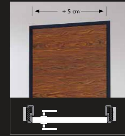
CUBE® Element Flächenverbund Tür | Zarge und Wand Blindstock mit Alu-Putzkante wird vor dem Verputzen in die Wand montiert
