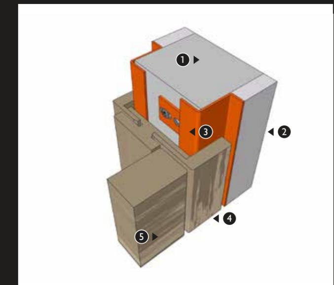
① Mauerwerk ② Putzoberfläche ③ Metall-Unterzarge
