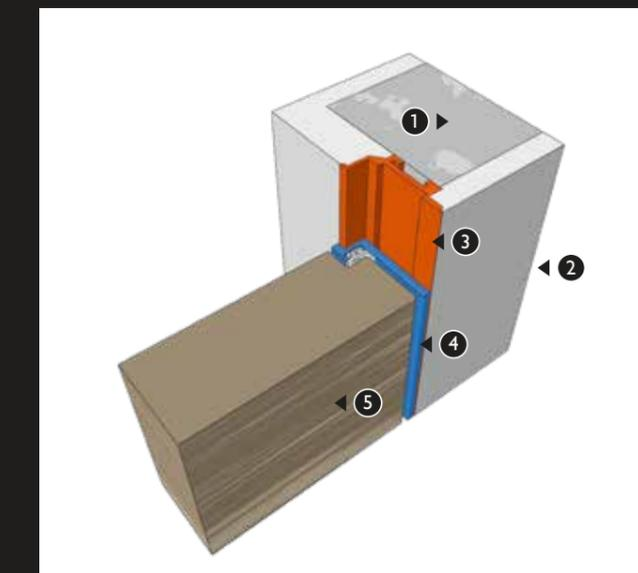
① Mauerwerk ② Putzoberfläche ③ Aluminium-Unterzarge ④ Aluminium-Deckzarge ⑤ 60 mm Türblatt
