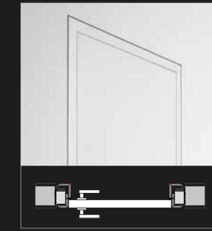
CUBE® Element Flächenverbund Tür | Zarge und Wand Blindstock mit Alu-Putzkante wird vor dem Verputz in die Wand montiert
